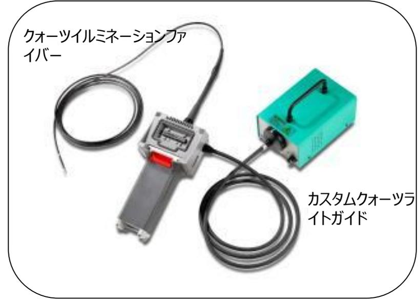
ガラスファイバーと比較して、高い透過率の石英ファイバーを使用することで波長の短い紫外線でもUV強度を補完します。ガラスファイバーは透過率、UV強度に差があります。
