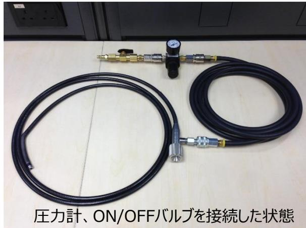
圧力計、ON/OFFバルブを接続した状態
