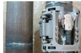
A、Cおよびセクタスキャンによる溶接部表示
