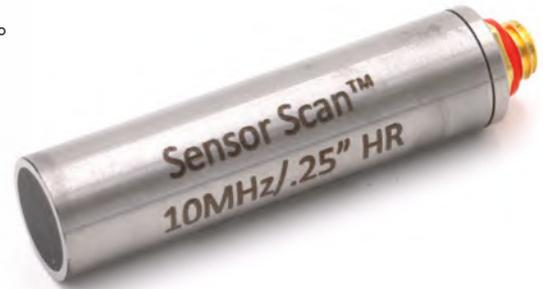
水浸探触子は自動探傷システムまたは手動検査において、水または他の液体を接触媒質として用い、複雑な形状の試験体のきず検出や、近距離分解能に優れた垂直探触子です。ポイントフォーカス、ラインフォーカスにより感度、分解能をさらに向上させます。
