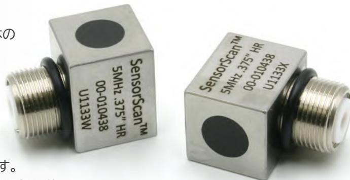
モデルIRは防水型UHFコネクタを探傷面に直角に取り付け、スペースが制限されるアプリケーションのための小型探触子です。振動子径は6mm、10mm、13mm(0.25、0.375、0.5インチ)より選択可能です。GPシリーズ\*は感度と分解能の最適な組み合わせにより、あらゆるアプリケーションに対応します。HRシリーズ\*は高いダンピング/広帯域で高分解能が必要なアプリケーションに適しています。Cシリーズ\*はコンポジット振動子となり、高減衰材等において優れた性能を発揮します。
