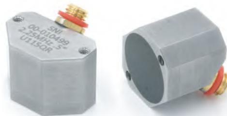
斜角探触子は垂直探触子では探傷が行えない試験体にウエッジを装着し斜めに横波を伝搬させ探傷するための探触子です。溶接部検査、チューブ、パイプ、タービンブレード、車軸などのアプリケーションに適しています。
