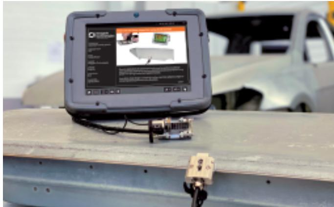
Krautkrämer Bond Scanner は、構造用接着剤で接合された部品を迅速かつ簡単に検査できます。
